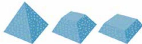
Die dreidimensionalen Strukturen der 3M™ Trizact™ Schleifmittel enthalten mehrere Schichten des Minerals. Durch das Abnutzen dieser Strukturen wird fortlaufend neues scharfes Schleifmaterial am Werkstück eingesetzt und ein gleichmäßigerer Abtrag während der gesamten Lebensdauer des Schleifbands erzielt.
